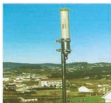
Sonda de medida de la radiación gamma <<
