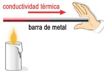
La capacidad de conducción del calor o **conductividad térmica**, es una propiedad física de cada sustancia y puede variar ligeramente en función de la temperatura y de las características particulares del material (humedad, etc).
