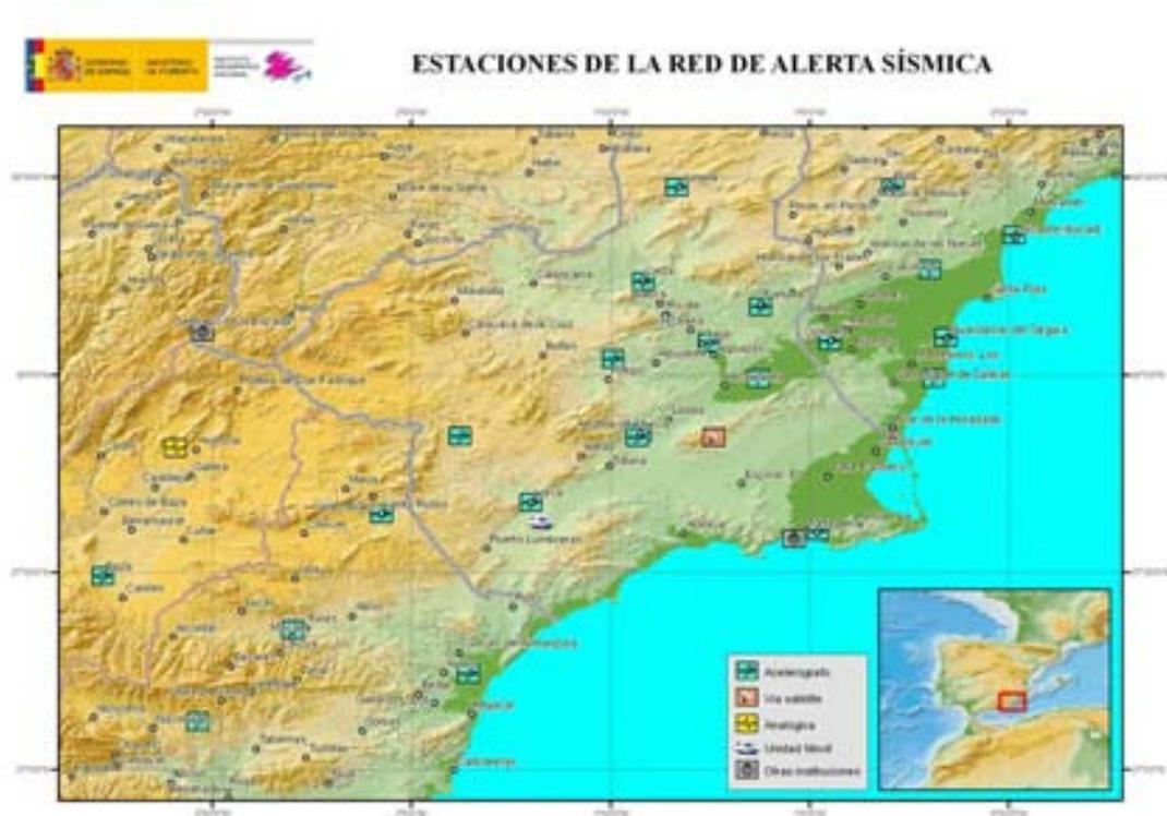
**Figura 2.20.** Estaciones sísmicas y acelerógrafos de la Red Sísmica Nacional y de otras instituciones, situadas en la región próxima al epicentro.
