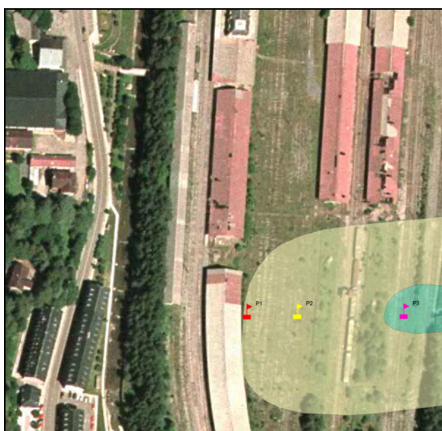
Figura 4. Detalle de los límites aproximados de la zona de llegada para un alud de placa húmeda (sombreado verde) y de placa seca (sombreado amarillo). Aparecen señalados los puntos de detención que proporcionan los distintos modelos
