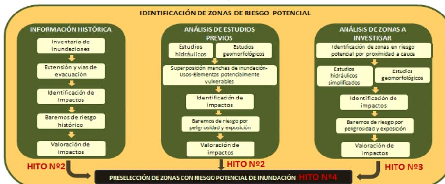
Fig.7.- Fase de identificación de las zonas de riesgo potencial, según la Guía Metodológica para el desarrollo del Sistema Nacional de Cartografía de Zonas Inundables. Evaluación Preliminar del Riesgo (Borrador v5.0)
