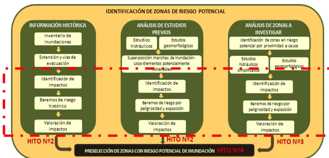
Fig.16.- Esquema metodológico de la identificación y valoración de zonas con riesgo potencial de inundación a partir de la Guía Metodológica para el desarrollo del Sistema Nacional de Cartografía de Zonas Inundables. Evaluación Preliminar del Riesgo (Borrador v5.0)
