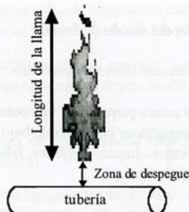
FIGURA 2.3. Representación esquemática de un dardo de fuego.
