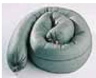
▣**TUBULARES:** Indicados para formar una barrera de contención, evitando que el derrame se extienda (longitud: 1,2-3 m.). Pueden emplearse tanto en interiores como en exteriores y son resistentes a productos químicos agresivos (disolventes, ácidos, bases...). Blandos y flexibles, pueden rodear máquinas que gotean o colocarse en ángulos o esquinas, formando barreras de contención que impiden el avance del fluido y contribuye a su absorción (hasta 10 l de aceite por tubular).
