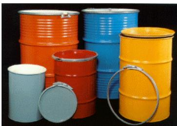
**BIDONES METÁLICOS DE APERTURA TOTAL:** aptos para el envasado de productos sólidos, semisólidos o pulverulentos. Homologados para el transporte de mercancías peligrosas. Reciclados, se fabrican con chapa de acero laminado en origen. Tapas desmontables con diversos tipos de cierres. Fijación de la tapa: palanca, ballesta o tornillo, todas con junta de estanqueidad. Acabado interior: con chapa (neutro) o recubierto con Epoxi. Capacidad: 200 l. Altura exterior: +/- 900 mm.
