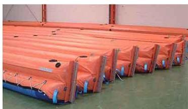
▣ **Selladoras**, indicadas para zonas de interfase entre agua y tierra. Están compuestas por tres compartimentos separados, uno superior que funciona de cámara de flotación y dos inferiores que se llenan de agua y actúan de lastre.
