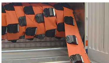
▣ **Permanentes**, indicadas para uso permanente en aguas expuestas. El diseño de los flotadores da una alta relación volumen/peso y una excelente estabilidad, garantizando una respuesta flexible y dinámica ante el oleaje. Pueden ir estibadas en carretes de accionamiento hidráulico para su despliegue, mientras que otras van plegadas en zig-zag en contenedores.
