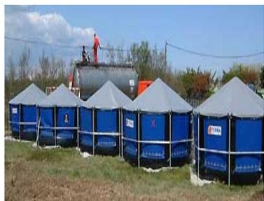
**DEPÓSITOS PARA ALMACENAJE** de hidrocarburos o líquidos contaminantes, especialmente indicados para intervención en situaciones de emergencia.
