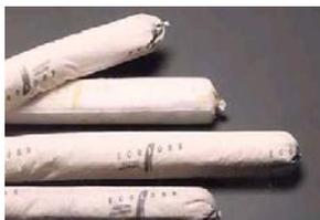
▣**TUBULARES:** Se trata de barreras eficaces para evitar que se extiendan los vertidos químicos (ácidos, bases, disolventes, compuestos aromáticos,...) sobre el suelo. Miden de 1,5-3 m. La absorción de los tubulares varía en función de su contenido, pudiendo ser de: microfibra pura, fibra artificial y carga mineral o vegetal.
