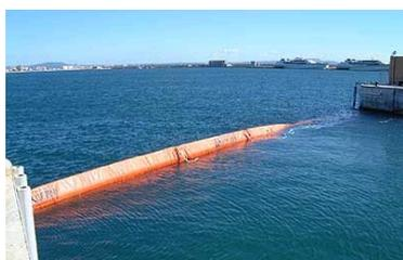
▣ **Sumergibles**, para zonas sometidas al tránsito de embarcaciones (dársenas, atraques, canales, etc.), donde se requiera el inmediato sellado de una zona contaminada y su rápida apertura (2 y 3 minutos respectivamente, según el sistema) para permitir el paso de dichas embarcaciones, pudiendo ser accionado por una sola persona.
