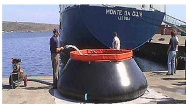
□ **Autoportantes:** tanques plegables autoportantes utilizados para el almacenamiento de hidrocarburos, agua potable y otros líquidos.
