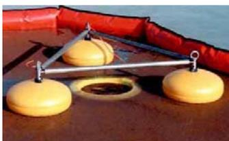
□Skimmers de rebosadero: permiten recuperar desde capas finas hasta capas gruesas variando la succión de la bomba. Hay modelos para aguas poco profundas y otros para alta mar, de forma que su peso aumenta con el calado máximo.
