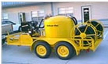
□**BOMBAS DE DESCARGA:** Diseñadas para la descarga o trasvase de productos de alta viscosidad al purgar tanques subterráneos, drenar cisternas, trampas de grasa, etc. Son portátiles y fáciles de utilizar. Su capacidad de descarga (30-140 m<sup>3</sup>/h) aumenta con el tamaño de la bomba (35-120 kg de peso).
