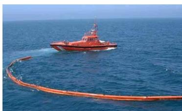
**BARRERAS DE CONTENCIÓN** de hidrocarburos o líquidos contaminantes para su uso en puertos, canales, aguas tranquilas o alta mar. Permiten contener derrames sobre la superficie del agua, constituyendo la primera medida de actuación para evitar la extensión de la mancha contaminante. Existen diferentes tipos:
