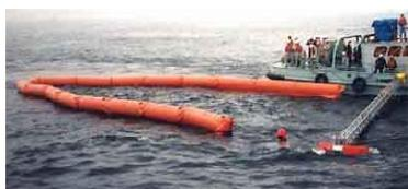
▣ **SISTEMAS DE BARRIDO**: permiten recuperar los hidrocarburos aprovechando las fuerzas hidrodinámicas del agua al concentrar el derrame en una zona. Así, se duplica casi la eficacia de los skimmers.
